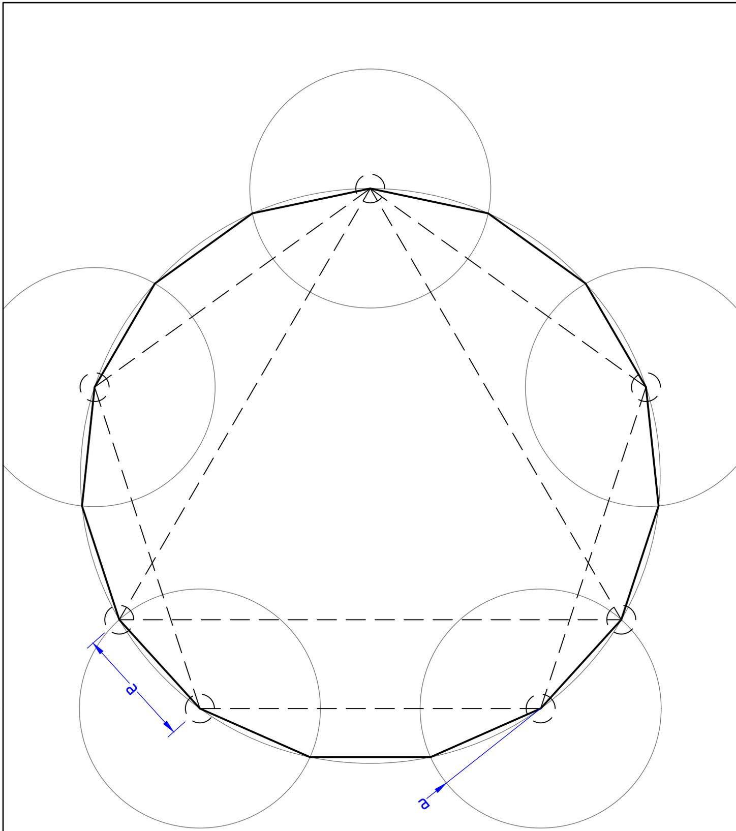
Näherungskonstruktion aus Drei- und Fünfeck
